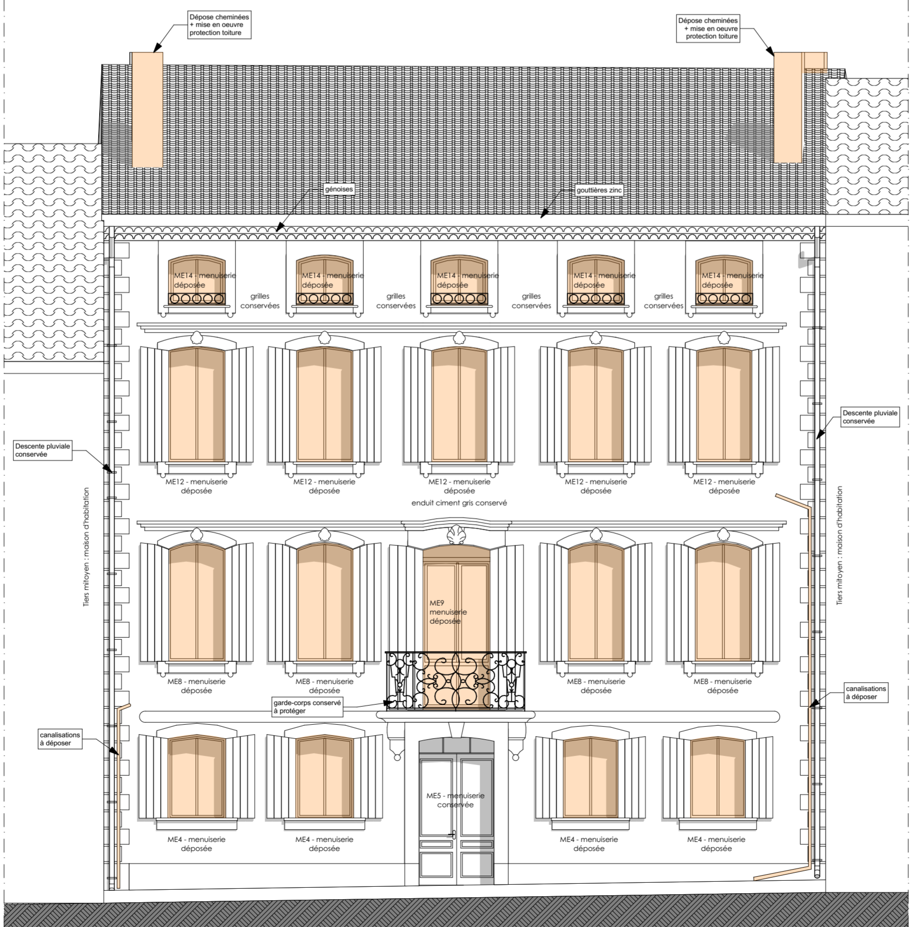
DEMOLITION Façade Ouest 1:75
